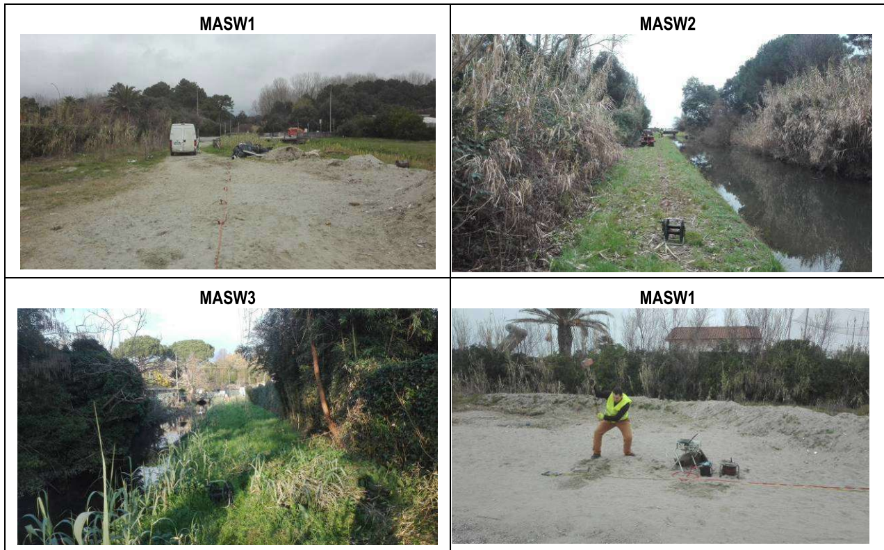
Figura n.11 - (Da sx a dx) Prospettiva sul profilo sismico Masw1, Masw2 e Masw3 e fase di energizzazione dello shot del Masw1.
