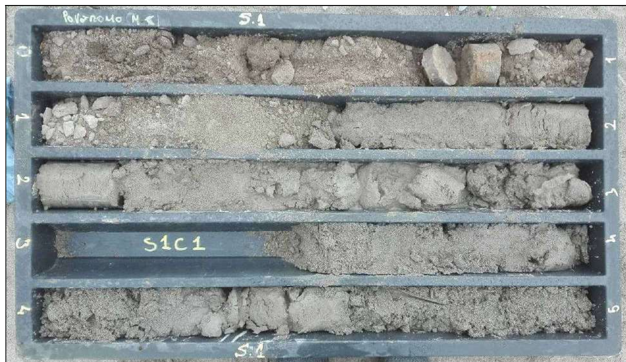
Foto 2: Stratigrafia da 0 a 5 m del sondaggio S1.
