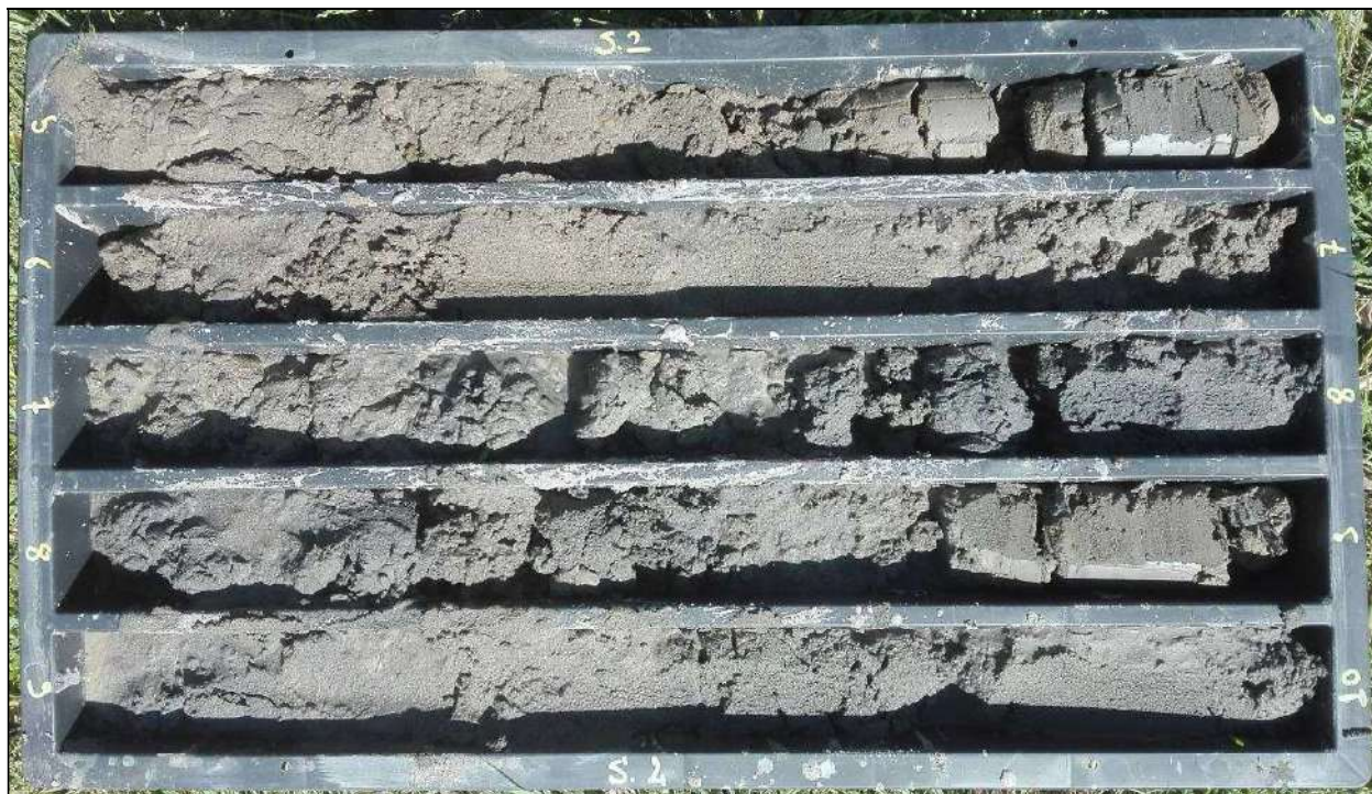
Foto 7: Stratigrafia da 5 a 10 m del sondaggio S2.
