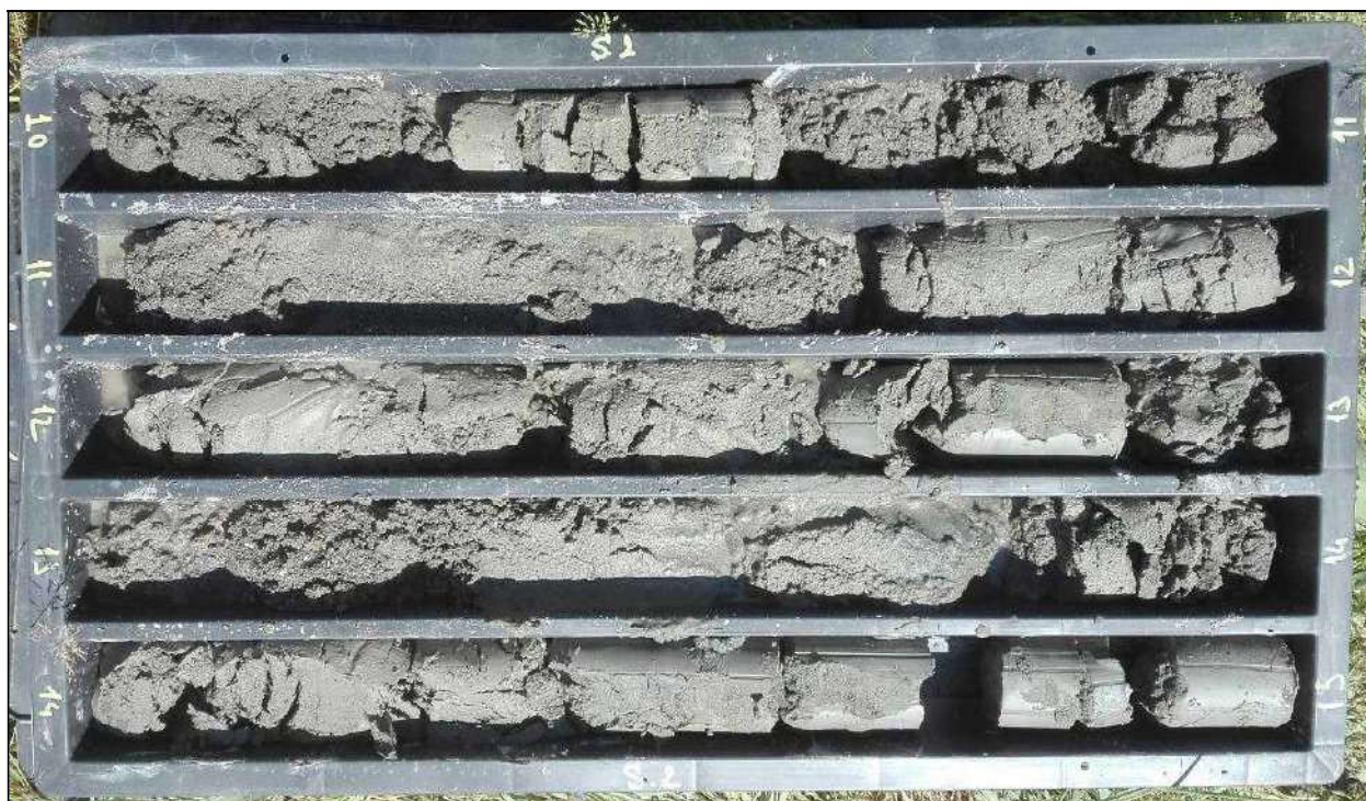
Foto 8: Stratigrafia da 10 a 15 m del sondaggio S2.
