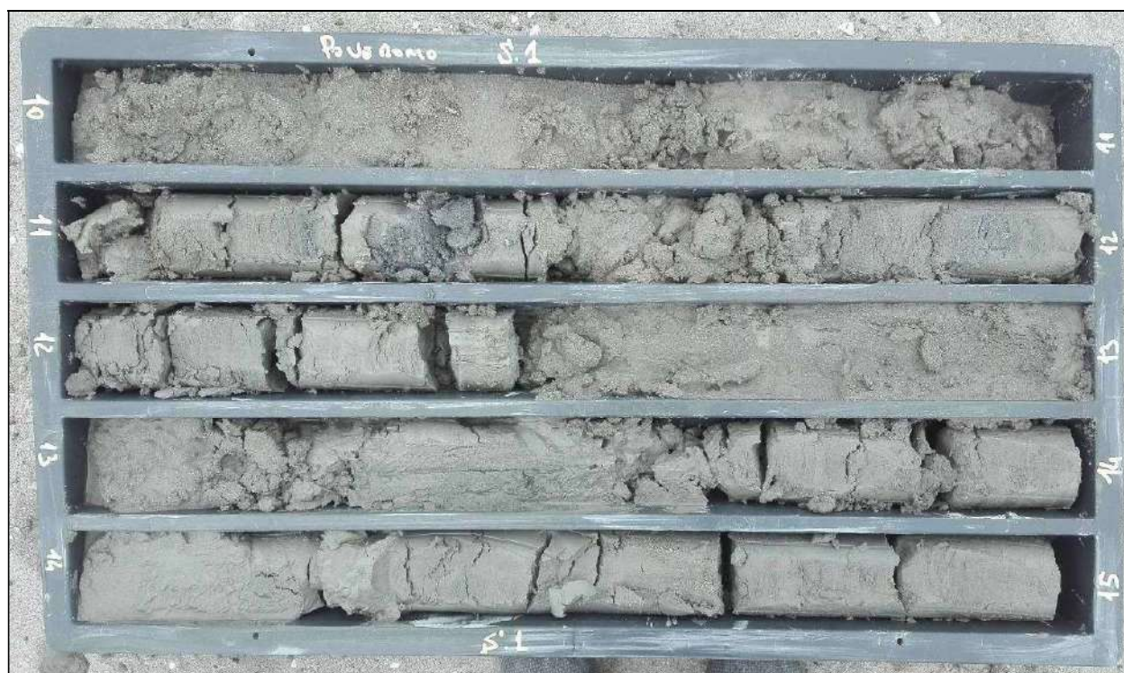
Foto 4: Stratigrafia da 10 a 15 m del sondaggio S1.
