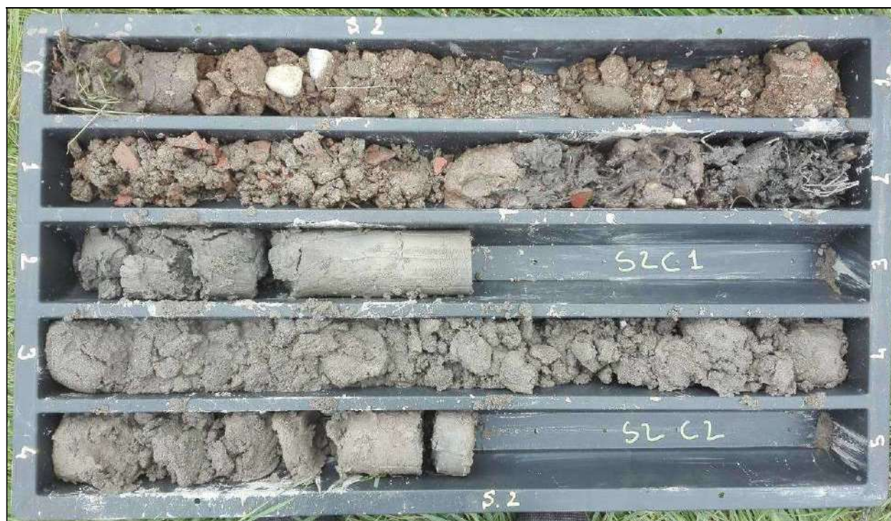
Foto 6: Stratigrafia da 0 a 5 m del sondaggio S2.
