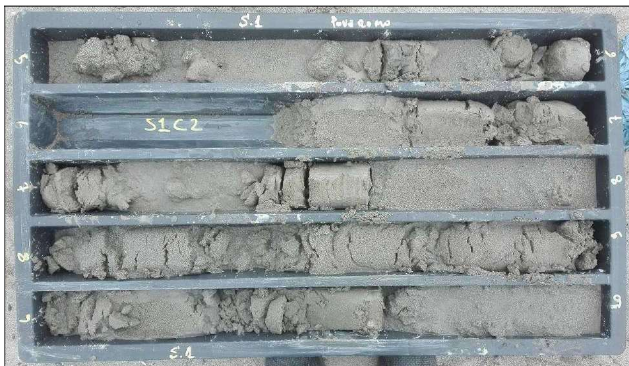
Foto 3: Stratigrafia da 5 a 10 m del sondaggio S1.
